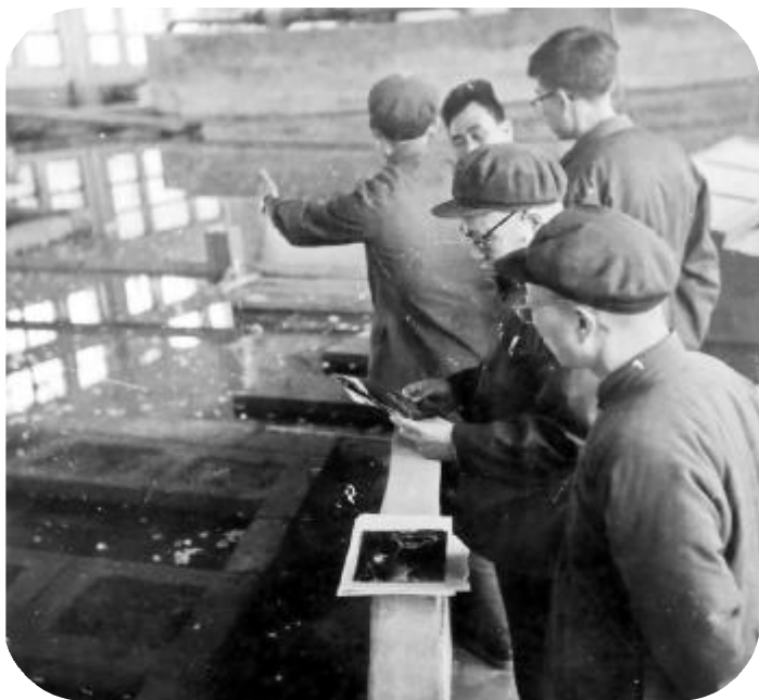
20 世纪 80 年代初的南京水利科学研究院河港研究所的连云港整体水流物理模型试验(赵鸣提供)
